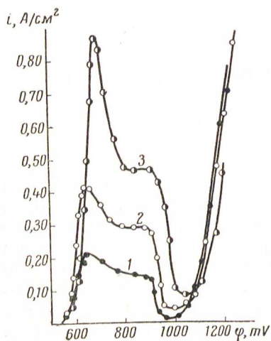
Рис. 3. Зависимость плотности тока от потенциала электрода для хромового катода в присутствии различных количеств серной кислоты: 1 — 2,5 г/л \text{H}_2\text{SO}_4 ; 2 — 5 г/л \text{H}_2\text{SO}_4 ; 3 — 10 г/л \text{H}_2\text{SO}_4
