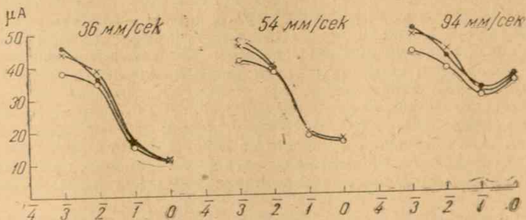
Рис. 3. Изменение тока максимума для раствора 0,001 \text{ N Hg}_2(\text{NO}_3)_2 + \text{KNO}_3 с логарифмом концентрации \text{KNO}_3 при разных скоростях течения ртути в капилляре
