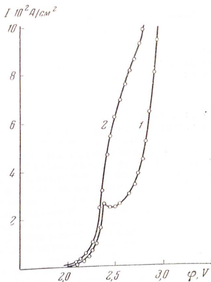
Рис. 2. Поляризационные кривые платинового анода в 15 N серной кислоте при различной скорости изменения потенциала: 1—10 мВ/мин.; 2—8 мВ/сек.
