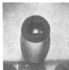
Fig. 5. Öltropfen mit Bläschen vor dem Loslösen von der Eisenkathode. Vergr. 7mal.
