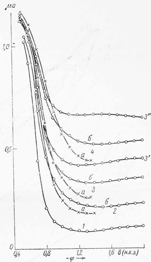
Рис. 3. Поляризационные кривые восстановления 10^{-3}N \text{K}_3\text{Fe}(\text{CN})_6 в присутствии \text{HCl} (а) и \text{LiCl} (б) в концентрациях: 1 — 0, 2 — 5 \cdot 10^{-4}N , 3 — 10^{-3}N , 4 — 2 \cdot 10^{-3}N и в присутствии 10^{-3}N \text{KCl} (3') и 10^{-3}N \text{CsCl} (3'')
