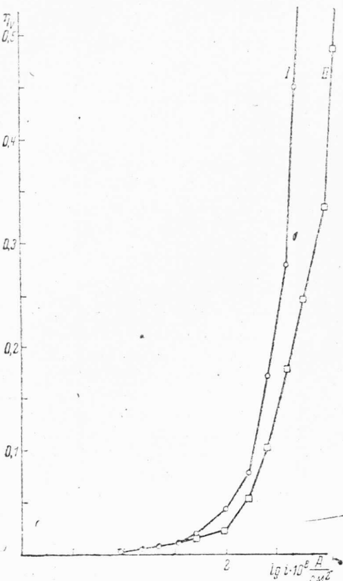
Рис. 8. Влияние размешивания на потенциал никелевого анода в 0,42 N: I — при слабом размешивании; II — при тройном увеличении скорости размешивания
