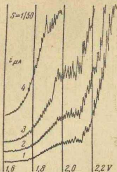
Рис. 3. Влияние HCl на полярограммы 0,01 M раствора \text{Pr}_2(\text{SO}_4)_3
