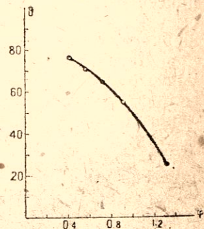
Рис. 6. Зависимость краевых углов вазелинового масла от потенциала. Платина.
