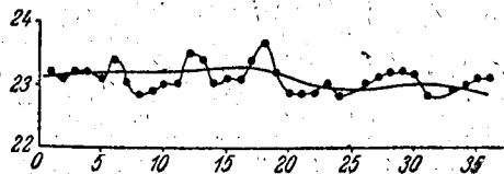
Рис. 5. Передвижение вершины резонансной кривой при отдельных опусканиях чашки.
