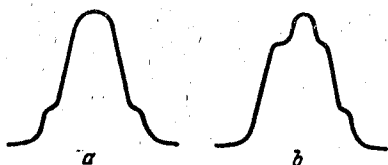
Рис. 5. Осциллографические кривые зависимости потенциала электрода от времени для обратимого (а) и необратимого (б) процессов
