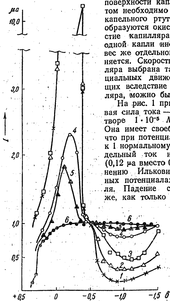
Рис. 2. Поляризационные кривые, полученные в растворе 1 \cdot 10^{-4} M K_2S_2O_8 в присутствии сернистого натрия разной концентрации: 1 — 1 \cdot 10^{-3} N Na_2SO_4 ; 2 — 3 \cdot 10^{-3} N ; 3 — 1 \cdot 10^{-2} N ; 4 — 5 \cdot 10^{-2} N ; 5 — 0,1 N ; 6 — 1,0 N .
